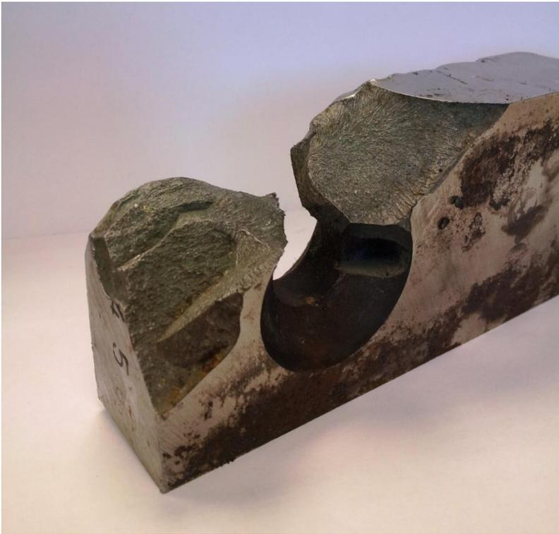
Die Schneidkante des folgenden Industriemessers zeigt ebenfalls starke Ausplatzungen, welche schon wieder verrunden. Das deutet darauf hin, dass die Ausbrüche bereits sehr früh im Betrieb aufgetreten sind. In der Folge nimmt die Schneide schnell ab, der Schnittspalt vergrößert sich und das Material wird mehr gequetscht als geschnitten, worunter die Qualität des Outputmaterials stark leidet.
